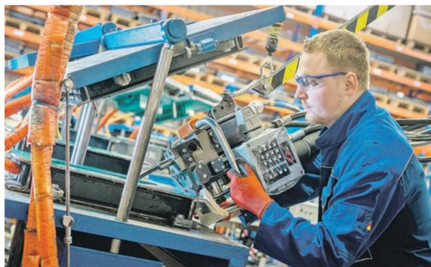
Produktionshelfer Clemens Möhn befüllt in der Pur-Schaum-Abteilung eine Form. Hier werden Teile für die Heizungsdämmung produziert. Foto: André Wirsig
