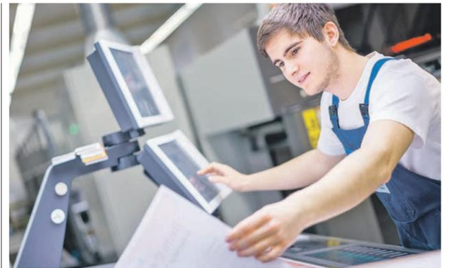
Jupp Langanki, Auszubildender zum Medientechnologe Druck im dritten Lehrjahr, am Leitstand einer neuen Bogenoffsetdruckmaschine.
